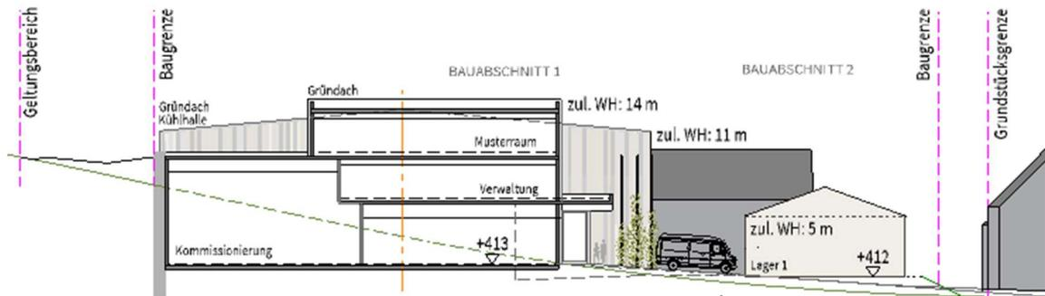
Abb.: Geländeschnitt durch Kommissionierung
