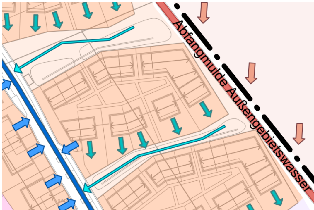
Abbildung 6: Auszug Fließwegekonzept liebald+aufermann (Anlage 2.1) mit Gehöft- entwässerung Mulden in Grünfingern (cyan) oder verrohrt über Kontrollschacht (blau)
