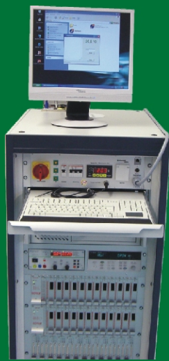
Prüfstand zur Umweltqualifikation von Anti-Blockier-System-Reglern
